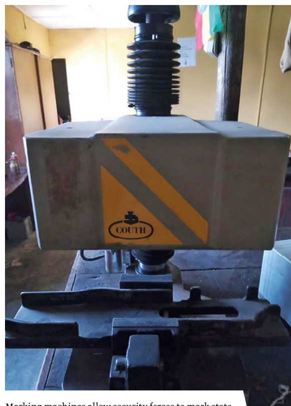
Marking machines allow security forces to mark state and civilian small arms, making their origin traceable Markierungsmaschinen ermöglichen es den Sicherheitskräften, staatliche und zivile Kleinwaffen zu kennzeichnen und so ihre Herkunft rückverfolgbar zu machen
